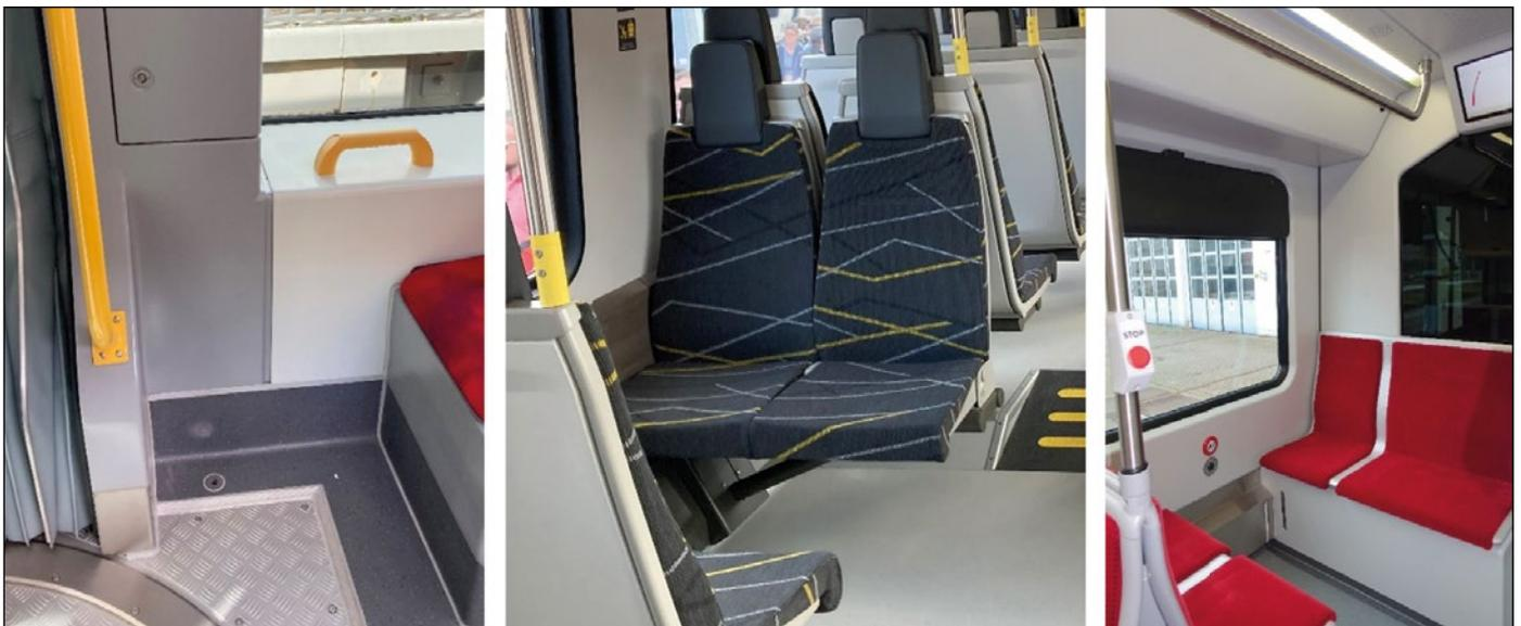
Abb. 2: Beispiel für Zündpositionen, die einen ungünstigen Brandverlauf erwarten lassen
